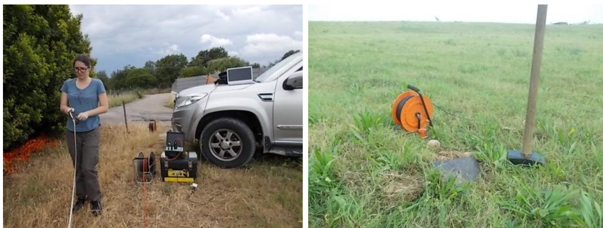
Sismografo utilizzato e punto di battuta
