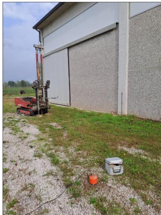
Misura del microtremore sismico mediante tecnica H.V.S.R.
