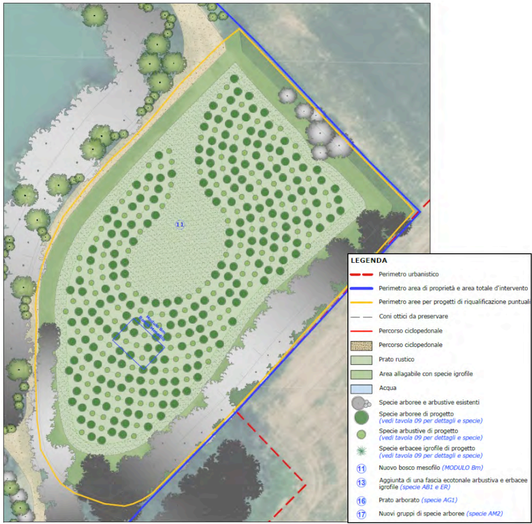
Figura 1-14: AREA 5 (estratto tavola 08 studio Zea 2024) -Il progetto prevede un intervento di formazione di un nuovo bosco sull'intera superficie, un tempo adibita a piazzale della ex cava. La messa a dimora del materiale di propagazione sarà eseguita in periodi idonei compresi tra fine autunno - inizio primavera. Nella realizzazione degli imboschimenti, gli impianti seguiranno una alternanza tra specie arboree e specie arbustive, tale da accentuare la variabilità delle stesse, favorendo lo sviluppo naturaliforme del sistema. Accertata l'irregolarità dell'intervento, valutato il contesto, si propone di mettere a dimora piantine forestali, fino al raggiungimento di una densità teorica di 1300 piante /ha.
