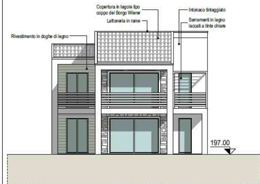
PROSPETTO OVEST - scala 1:200
