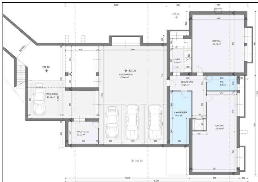
Edificio A - Piano Interrato
