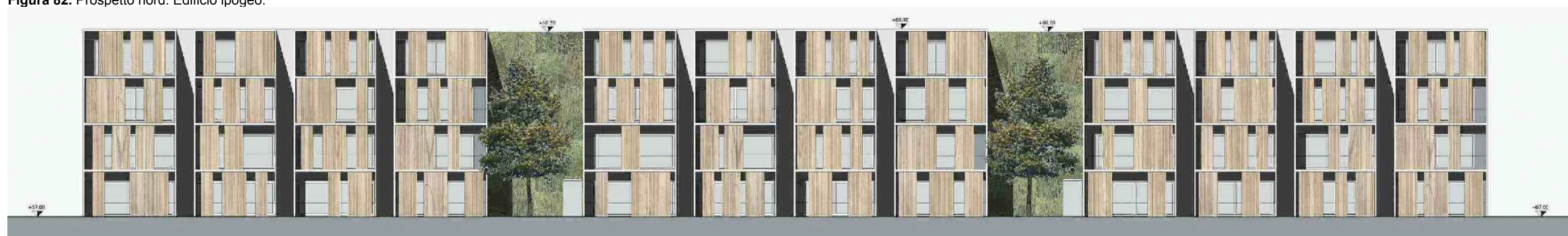
Figura 83. Prospetto Nord ovest. Si evidenziano le pareti a verde "verticale" che suddividono i tre blocchi edilizi in corrispondenza dei vani scala.
