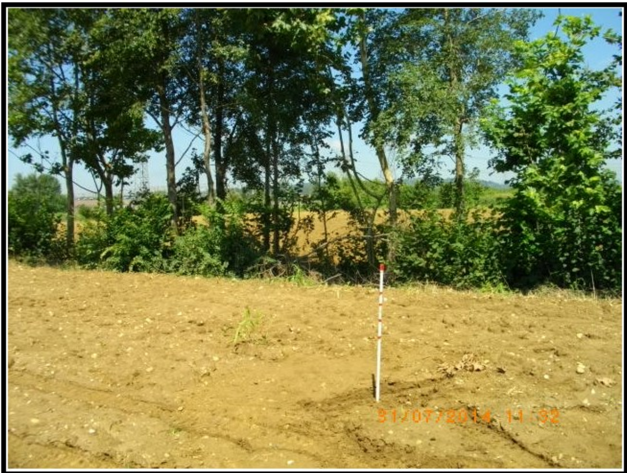
Fotografia 1. Piezometro posizionato in sito all'interno del foro prova CPT1
